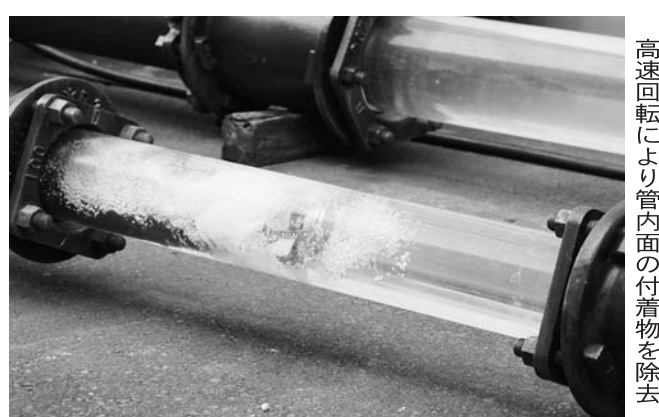
口径に合わせて洗浄ヘッドを使い分ける
