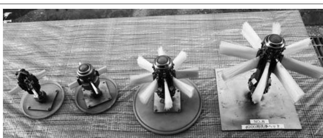
口径に合わせて洗浄ヘッドを使い分ける
